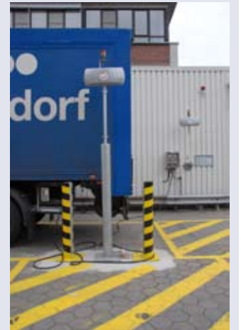
Zwei an den Verladeplätzen auf dem Freigelände installierte Reader erfassen den Verladeprozess.
