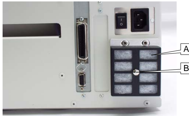
[7] 64-08 mit angebautem Staubfilter (A).
