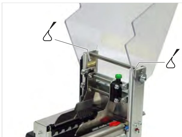
Bild 6: Führungen des Messerschlittens.
