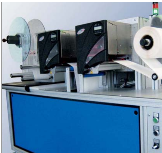
[6] Anwendung mit zwei PEM-Modulen für zweifarbigen Druck. Zwischen den beiden PEMs befindet sich eine Pufferschleufe. Links wird das bedruckte Material aufgewickelt.
