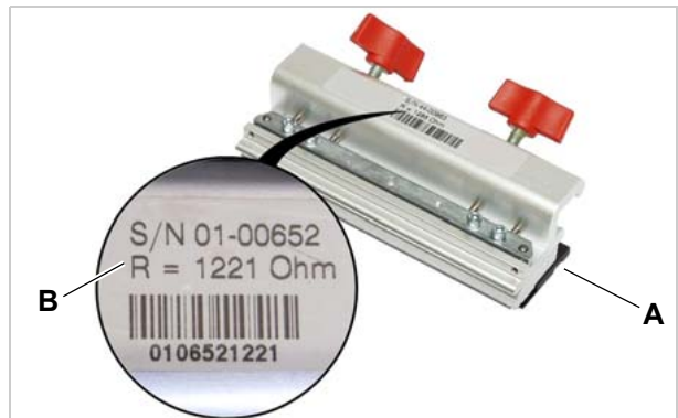
[62] Druckkopf (A) mit Widerstandskennzeichnung (B), hier: 1221 Ohm.
