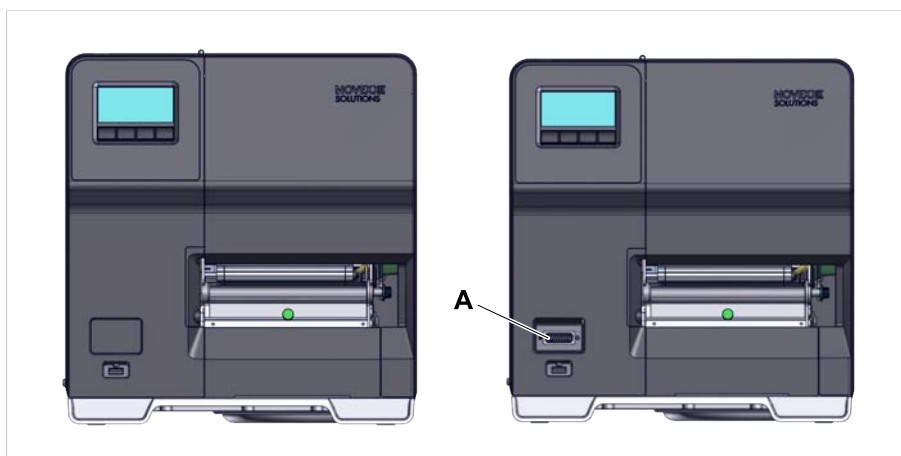
Bild 9: Äußeres Unterscheidungsmerkmal: Die „Peripheral“-Version (rechts) hat einen Sub-D-Anschluss (A) an der Vorderseite, unterhalb des Bedienfeldes.
