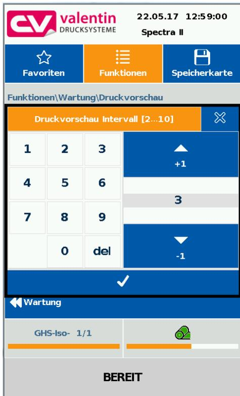
Während eines laufenden Druckauftrags wird die Vorschau im eingestellten Intervall aktualisiert.
