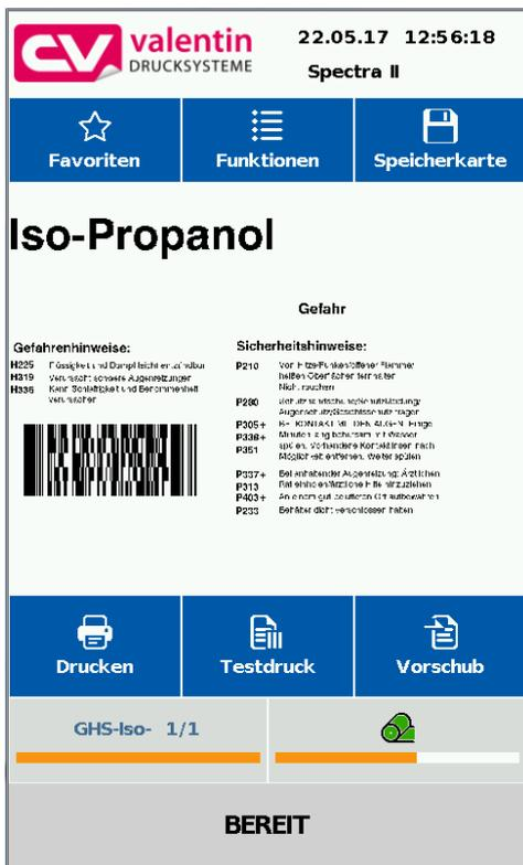
Bei aktivierter Druckvorschau wird auf dem Display ein Bild des aktuell gedruckten Layouts angezeigt. Ist die Funktion nicht aktiviert, bleibt das Feld leer.
