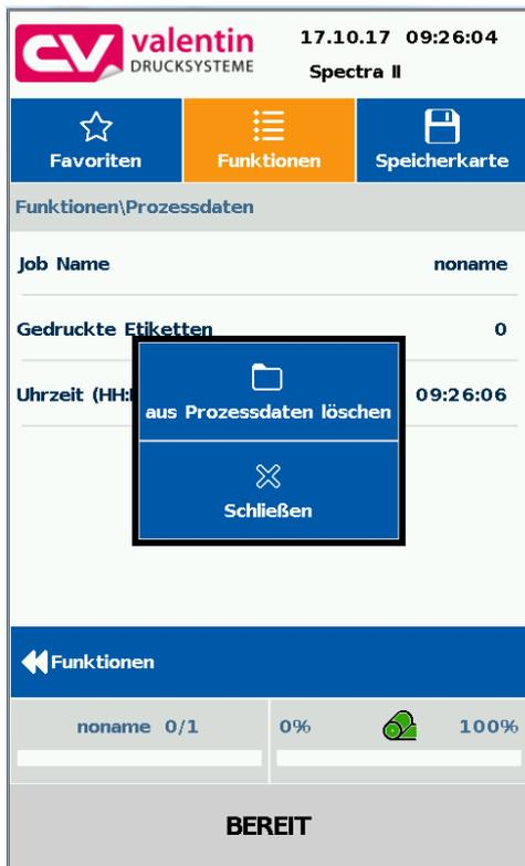
Durch langes Drücken (2 s) auf einen Parameter (z.B. aktuelle Uhrzeit) wird die zugehörige Auswahl angezeigt. Mit *aus Prozessdaten entfernen* wird der ausgewählte Parameter von der Liste entfernt.
