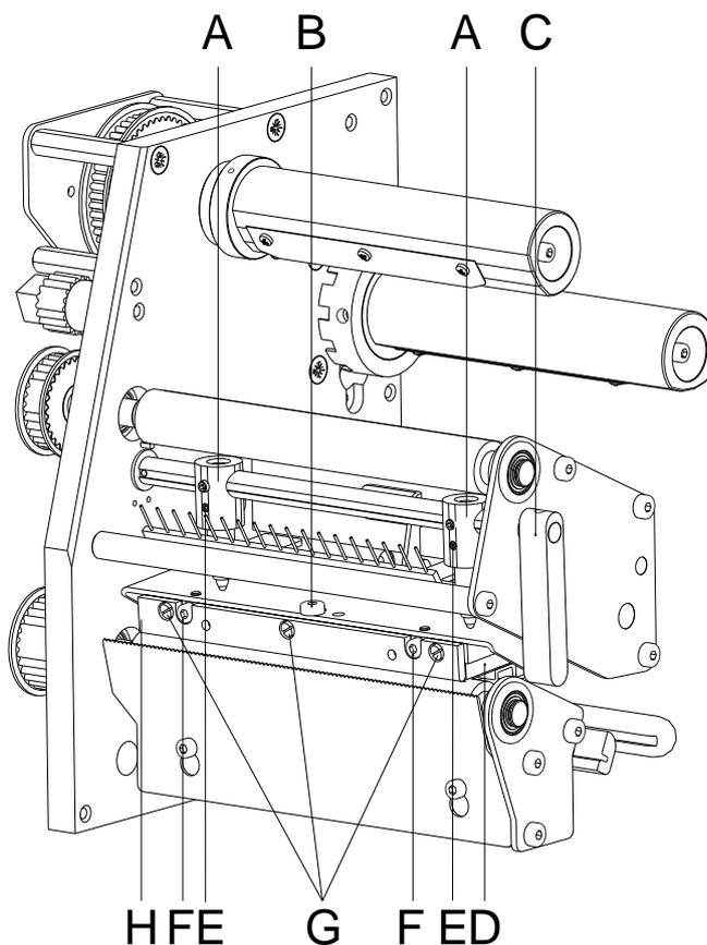
Für ein sauberes Druckbild ist die einzustellende Parallelität der Brennlinie des Thermodruckkopfes zur Andruckwalze ein wichtiges Kriterium. Da die Position der Brennlinie auf dem Druckkopf fertigungsbedingten Schwankungen unterliegt, ist es nach einem Druckkopfwechsel z.T. notwendig die Parallelität einzustellen.
