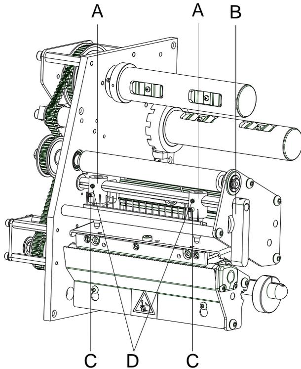
Eine Erhöhung des Kopfandrucks führt auf der entsprechenden Seite zu einer Verbesserung der Druckbildschwärzung und zu einer Verschiebung des Bandlaufs in die entsprechende Richtung.
