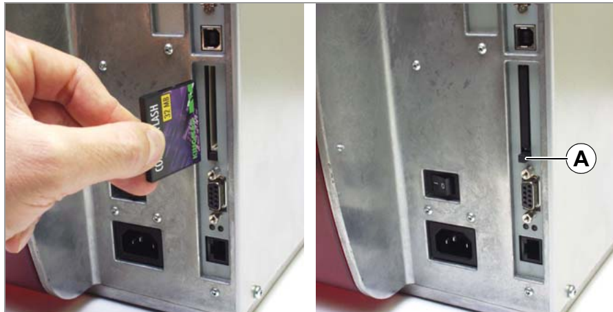
[15] Einstecken einer CF-Karte. Wenn die CF-Karte korrekt eingeschoben ist, schließt sie bündig mit der Drucker-Rückwand ab (rechts).
