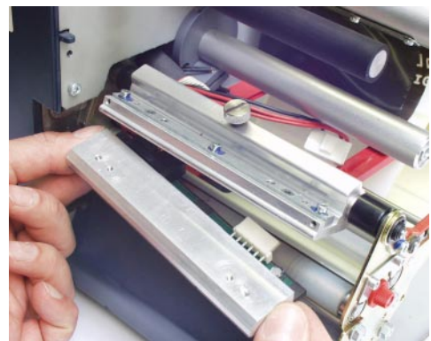
[3] Druckkopf ausbauen am TTX x50/Wildcat: Imbusschrauben (1) herausdrehen, Rändelschraube (2) lösen. Druckkopf abnehmen.
