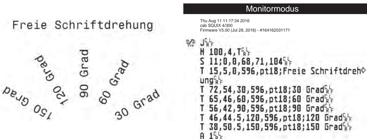
Bild 17 Beispieletikett normal gedruckt (links) und im *Monitormodus* (rechts)
