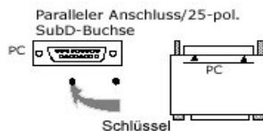
Abbildung 2: Anschluss des Dongles an den Parallelport Ihres
